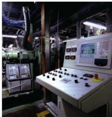
Die zentrale Visualisierung über Simatic OP37/Pro macht die Profilextrusion bei Hutchinson einfacher, sicherer und präzise
