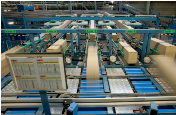
Die RFID-Applikation bei SIG Combibloc überwacht mit vier Antennen an einem einzigen Reader fünf Bahnen
