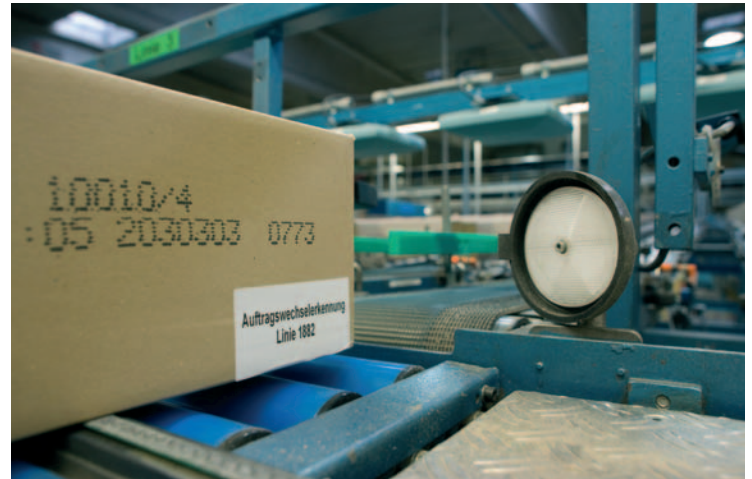
Ein elektronisch codiertes und zusätzlich bedrucktes SmartLabel kennzeichnet den jeweils letzten Karton eines Auftrags
